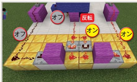
▲2つのコンパレーターから出る信号がオンに。たいまつで反転されるので出力回路に信号は伝わず、ドアが開く。
