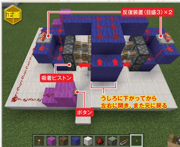
▲ドアを動かすのは吸着ピストン。開くのは吸着ピストンが一般ブロックを引きつけたとき。閉じるのは、吸着ピストンが一般ブロックを押し出したときだ。
